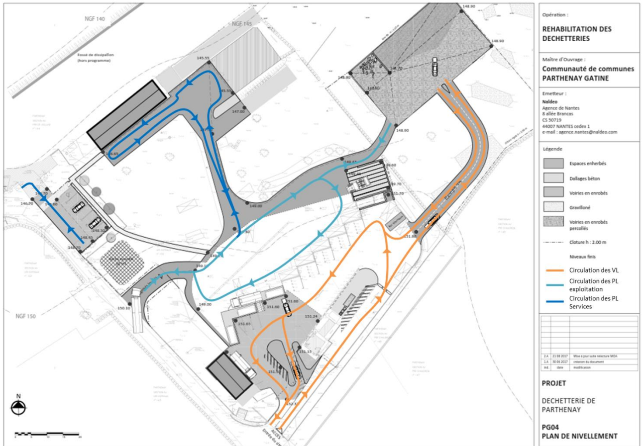
Figure 53. Flux de circulation de la déchèterie
